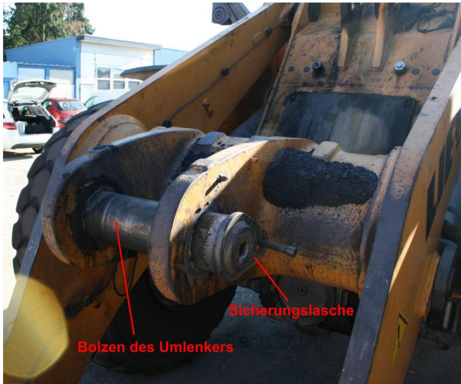
Hubgerüst mit Bolzen des Umlenkers
