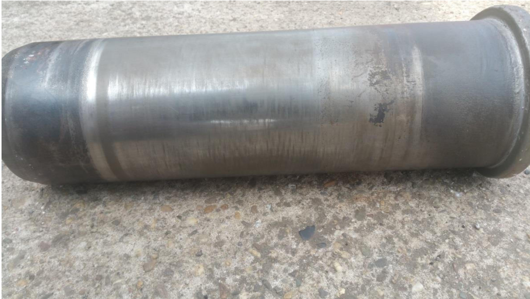
Ausgebauter Lagerbolzen, gereinigt
